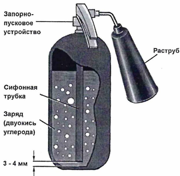
При возникновении очага возгорания необходимо снять огнетушитель и поднести к очагу, выдернуть чеку, направить раструб в сторону огня, нажать на рычаг запорно-пускового устройства и приступить к тушению очага возгорания (правила применения также указываются на корпусе огнетушителя).
